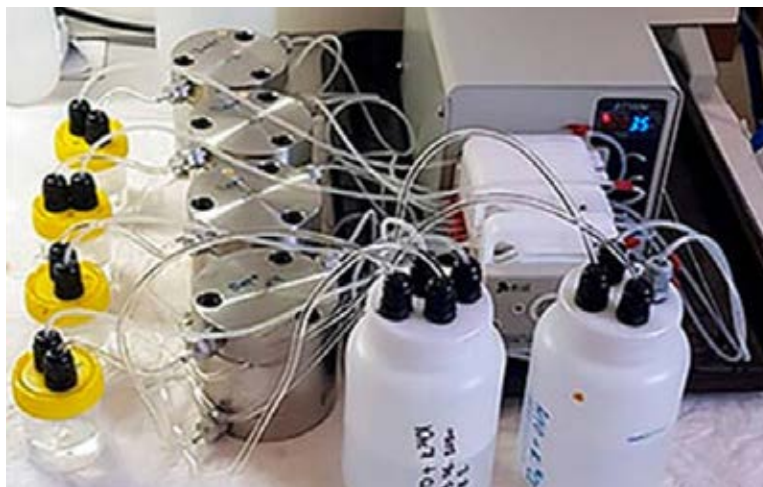
Рис. 7. Лабораторная установка для определения свойств барьерных материалов (фото derlab.ru)
